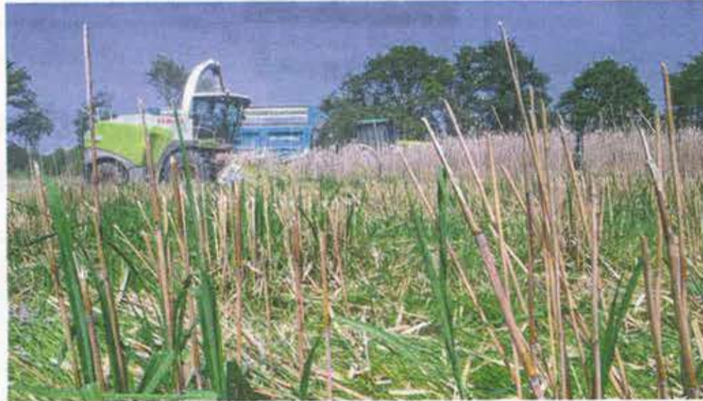
La récolte de miscanthus se réalise avec une ensileuse classique.
